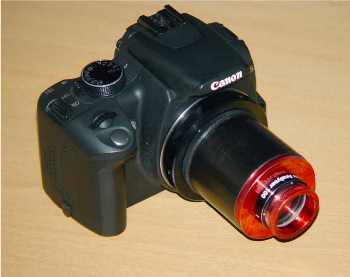
La imagen anterior muestra el conjunto completo de SA y prisma, montados sobre un tapón de aluminio y este sobre un adaptador de 2" a rosca T2. La cámara, una Canon 350D, tiene un anillo adaptador de bayoneta Canon a rosca T2.
