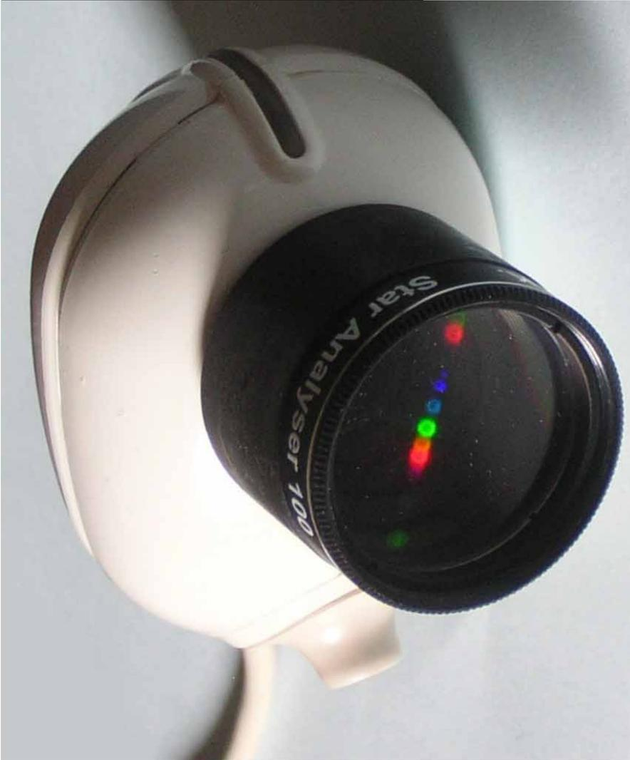
Webcam modificada con un tubo adaptador de 1 ¼ pulgadas y el SA roscado en el tubo.
