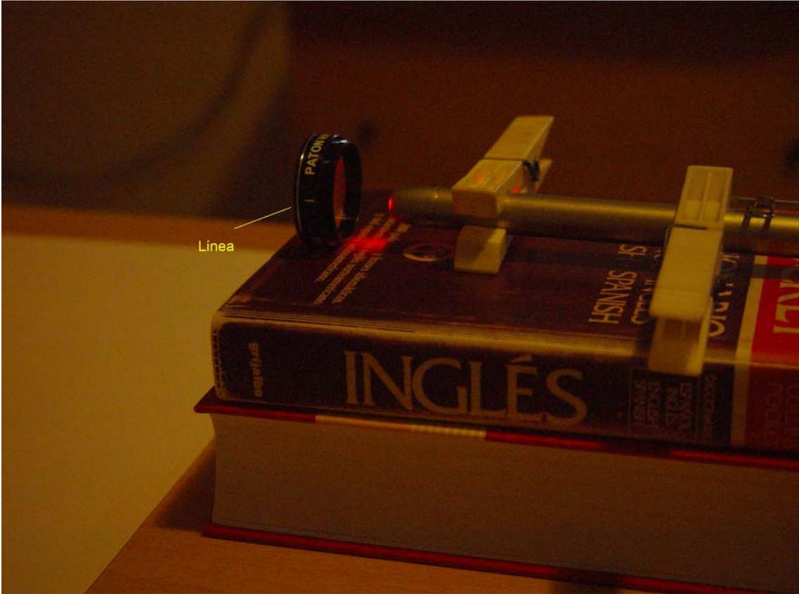
Sujetar un folio de papel sobre una caja a modo de pantalla de proyección y activar de forma permanente el puntero con una gomilla, clip, etc.
