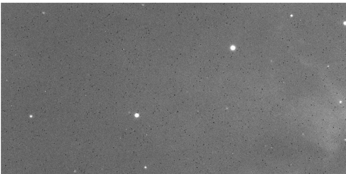
Los pequeños puntos negros de la imagen corresponden a "cold pixels"
