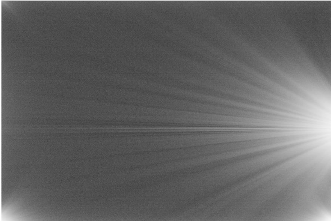
Ruido típico de "Amp Glow" de una cámara ZWO ASI 183
