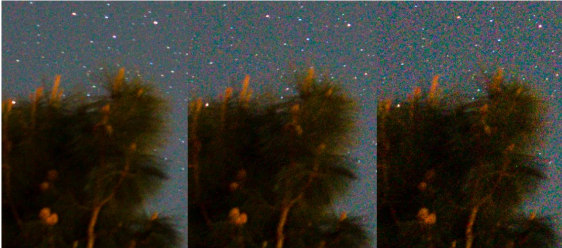
De izquierda a derecha se puede apreciar el incremento de ruido de ganancia al aumentarse la ganancia del sensor
