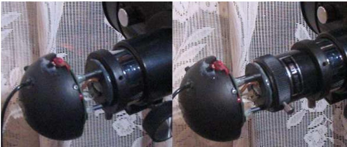
El método de proyección de ocular es el que ofrece la mayor cantidad de aumentos y consiste en poner un ocular, y sobre éste, la webcam. También puede ir una lente barlow. El ocular debe ser de aumentos, por ejemplo un Plossl de 6.5mm. Hay que prestar atención de que la webcam no quede torcida cuando se la acopla al ocular sino en la imagen tenemos una parte enfocada y la otra no. El método es así:
