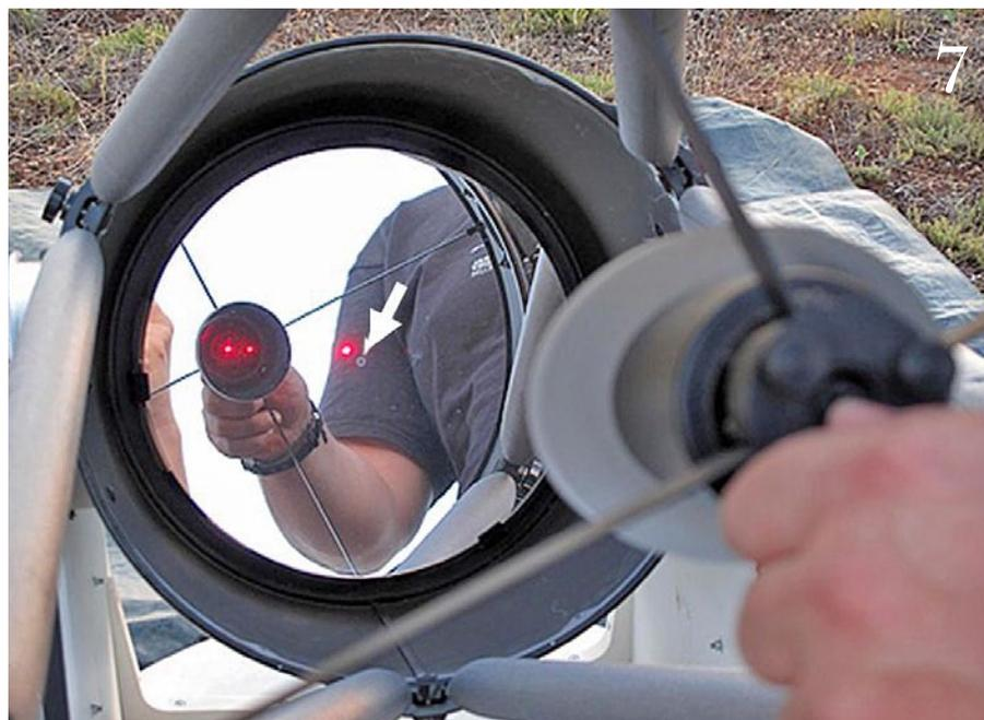
**FIGURA 7** Colimación del espejo secundario con un láser. En la imagen superior el rayo que incide en el espejo primario se encuentra a un par de centímetros de la marca central del espejo primario (flecha blanca). En la imagen inferior el punto incidente está centrado en la marca. El espejo secundario ya está alineado.
