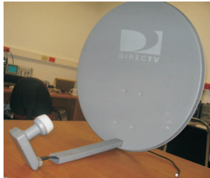
Figura 12: Adaptar el LNB a la antena.
