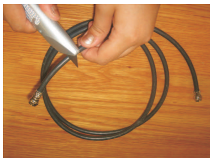
Figura 3: Cortar totalmente un extremo del cable coaxial.
