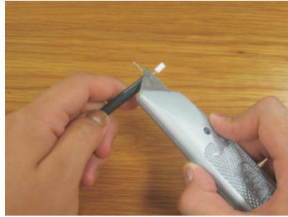
Figura 6: Desprender el aislante (plástico blanco).
