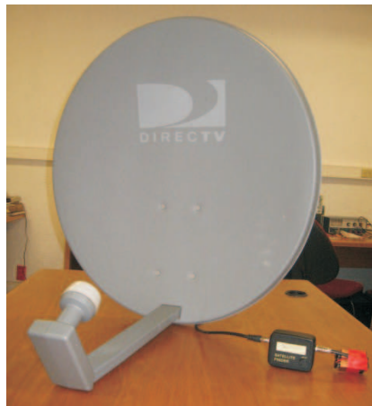
Figura 12: Adaptar el LNB a la antena.
