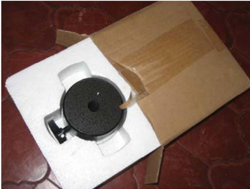
15.- Abrimos el estuche E que contiene el **CONTRAPESO** del tubo del telescopio y guardamos su envoltorio
