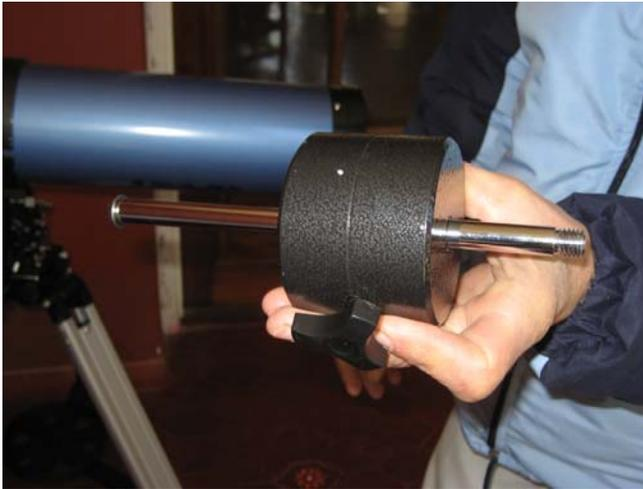
17.- Una vez “escondido” el “eje”, pasamos por el orificio el **PERNO DEL CONTRAPESO** mencionado en el punto 9 y ubicado en la caja C
