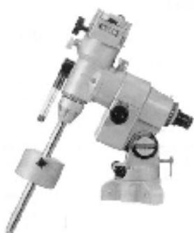
La típica montura ecuatorial alemana, la más usada por los astrónomos aficionados, con sus dos ejes principales.
